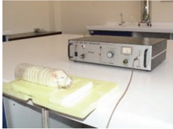
Resim 1. 900 MHz radyo dalgası üreten cihaz ve düzenegi
